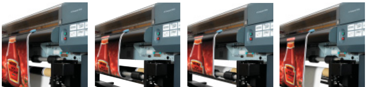
Detalhe do Take-Up Reel com quatro modos de bobinagem
